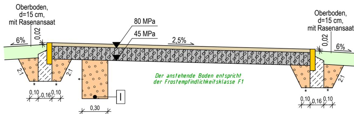
\* Arbeitsraumverfüllung mit verdichtungsfähigem Boden (möglichst aus der Baustelle gewonnen)
