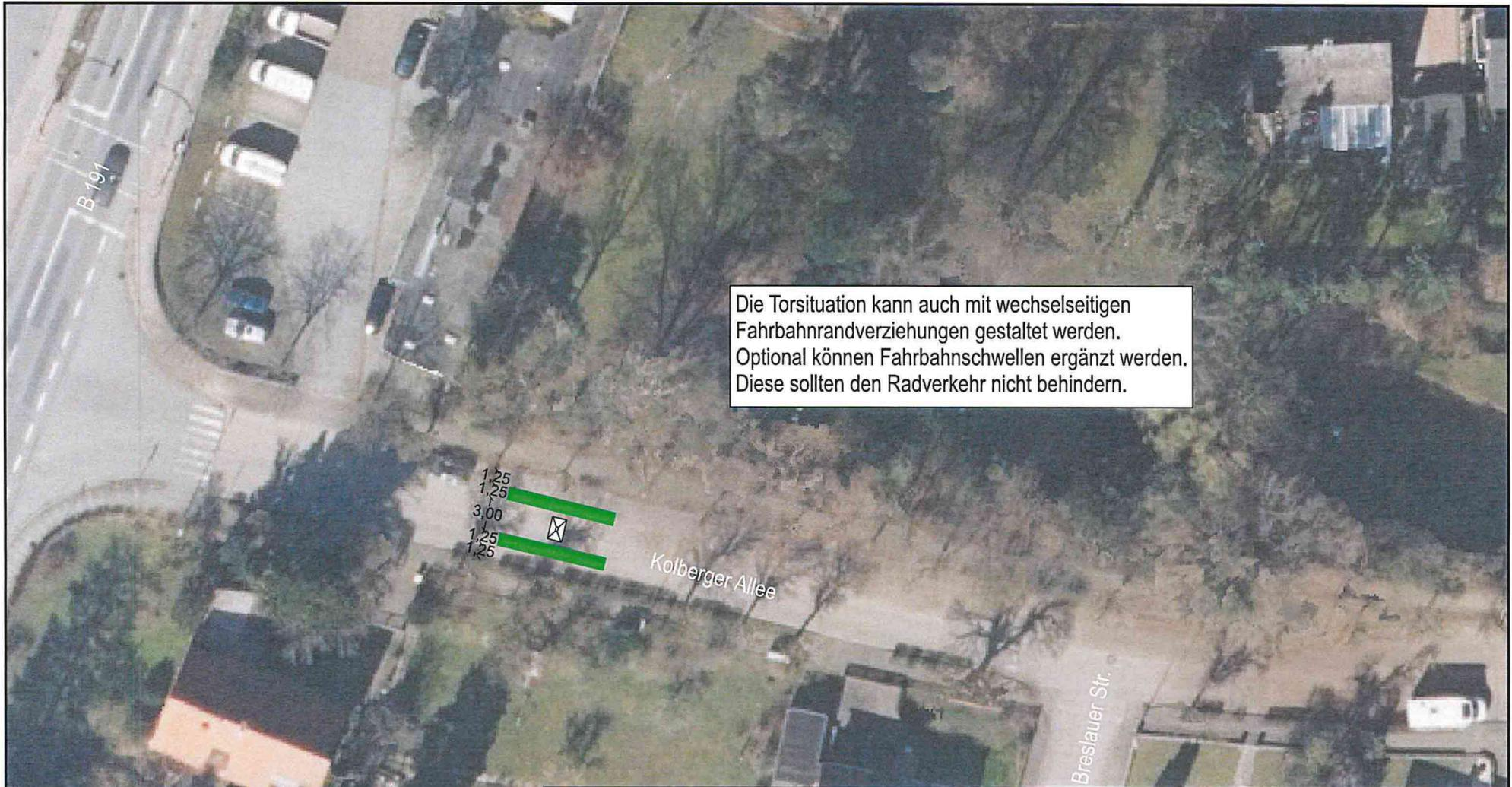
Die Torsituation kann auch mit wechselseitigen Fahrbahnrandverziehungen gestaltet werden. Optional können Fahrbahnschwellen ergänzt werden. Diese sollten den Radverkehr nicht behindern.
