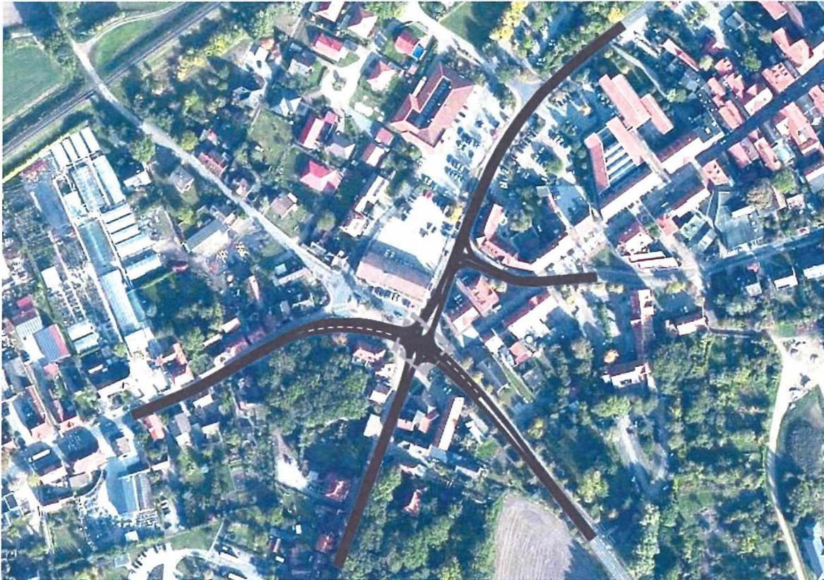
Abbildung 3: Vissim-Netzmodell (Analysevariante)
